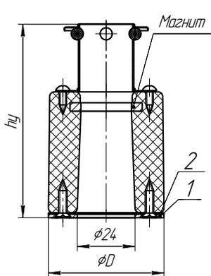
Массу обеспечить подбором груза поз.1 и шайб поз.2.
