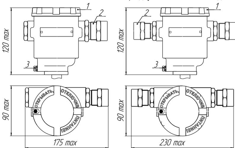
1 - крышка, 2 - кабельный ввод; 3 - внешний зажим заземления
